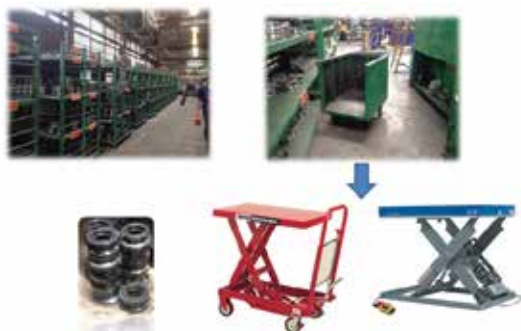
รูปที่ 2: โครงงาน Roller Cart ให้สามารถปรับระดับได้และถูกหลักของการยศาสตร์
