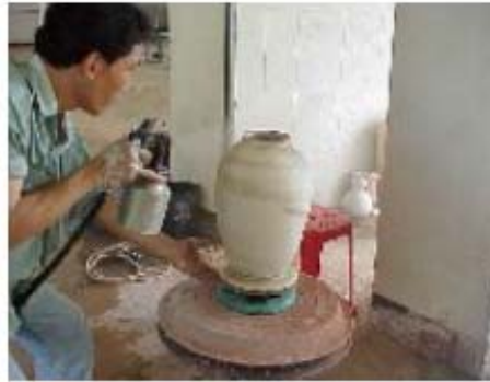
รูปที่ 2-30 การพ่นเคลือบผลิตภัณฑ์
