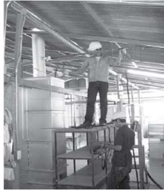
รูปที่ 2-40 การตรวจวัดมลพิษทางอากาศจากปล่องระบายอากาศเตาเผาเซรามิก
