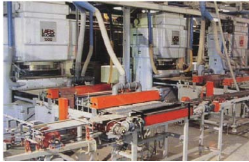
รูปที่ 2-27 การขึ้นรูปกระเบื้องด้วยวิธีการอัด
