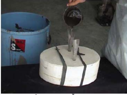
(1) การเทน้ำดินแบบหล่อต้น
