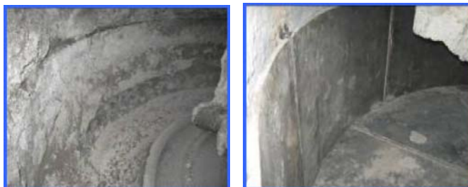
รูปที่ 3-17 สภาพถังกวนก่อนและหลังปรับปรุง
