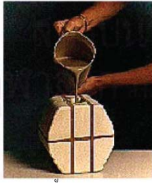
(1) การเทน้ำดินใส่แบบพิมพ์ปูนปลาสเตอร์
