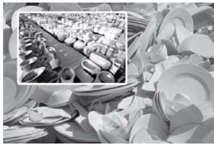
รูปที่ 2-36 ของเสียเซรามิกประเภทเศษเครื่องใช้บนโต๊ะอาหาร และเครื่องสุขภัณฑ์ที่ไม่ได้มาตรฐาน
