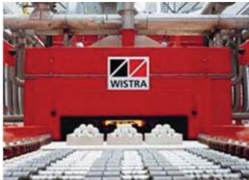
รูปที่ 2-34 เตาเผาแบบโรลเลอร์ฮาร์ด
