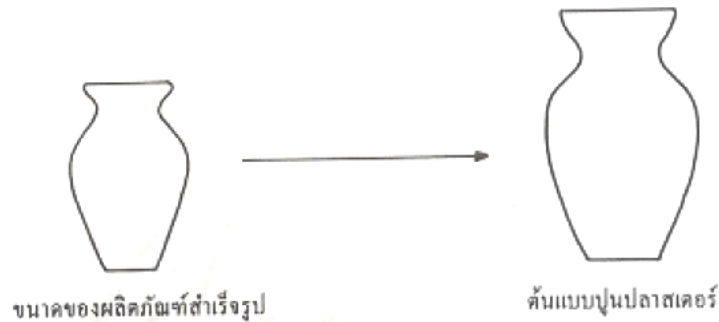
รูปที่ 2-20 การเตรียมแบบพิมพ์เหมือนต้นแบบ
