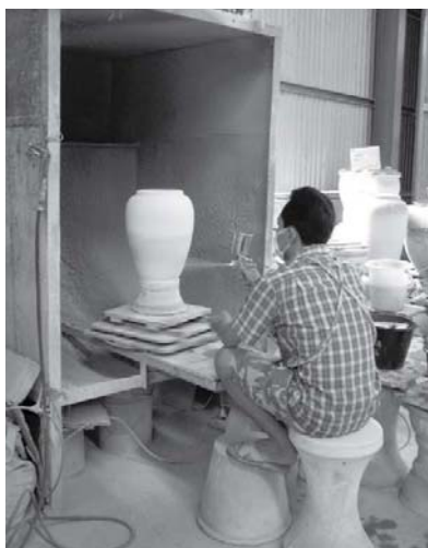
รูปที่ 4-3 ตู้ปั้นเคลือบชิ้นงาน
