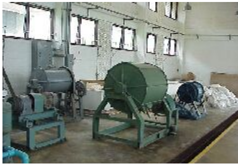
รูปที่ 2-16 เครื่องมือและอุปกรณ์สำหรับการบด/ย่อย เพื่อลดขนาดวัตถุดิบชนิดต่าง ๆ
