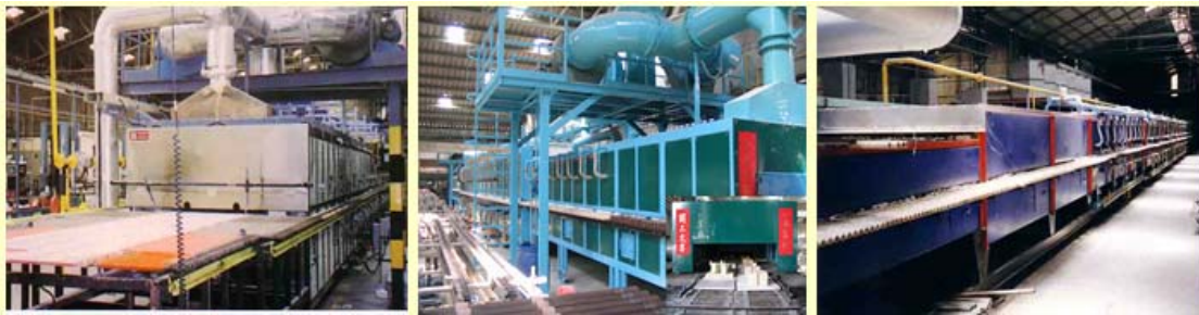
รูปที่ 2-33 เตาเผาแบบโรลเลอร์
