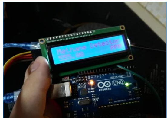
ภาพที่ 3.17 ทดสอบเซนเซอร์ MQ-4
