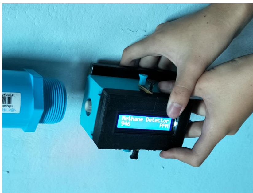
การทดลองจุดไฟและวัดปริมาณความเข้มข้นของก๊าซมีเทน
