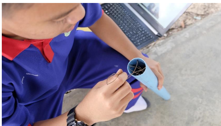
ภาพที่ 3.14 นำสนิมเหล็กและซิลิกาจากเกลือใส่ท่อ PVC
