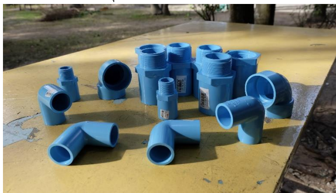
ภาพที่ 3.25 การเตรียมข้อต่อท่อPVCสำหรับพัฒนาระบบก๊าซชีวภาพ
