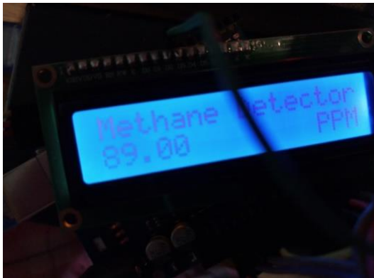
ภาพที่ 3.17 ทดสอบเซนเซอร์ MQ-4
