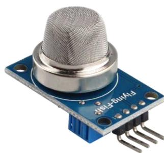
ภาพที่ 2.29 โมดูลเซนเซอร์ MQ-4 สำหรับตรวจวัดก๊าซมีเทน
