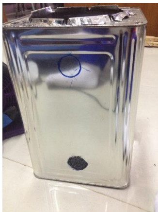
ภาพที่ 3.10 การเจาะรูด้านข้างของปั๊ม
