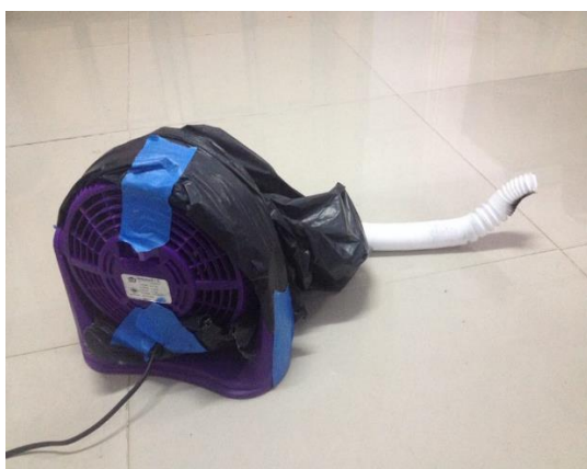
ภาพที่ 3.11 การดัดแปลงพัดลมและนำมาประกอบเข้ากับตัวปั๊ม
