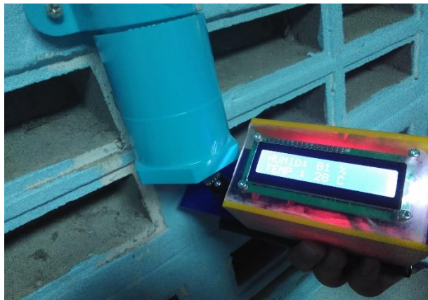
ภาพที่ 3.33 วัดปริมาณความชื้นสัมพัทธ์ของก๊าซชีวภาพก่อนและหลังผ่าน Purifier
